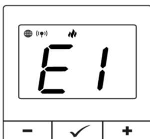
E1 - Skrat v obvode vnútorného snímača teploty
