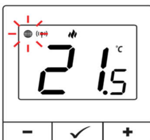
E1 - Skrat v obvode vnútorného snímača teploty
