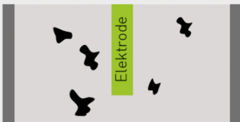
01 Jemné čiastočky prachu prúdia so spalinami cez výmenník tepla a potom do trubic integrovaného E-filtra
