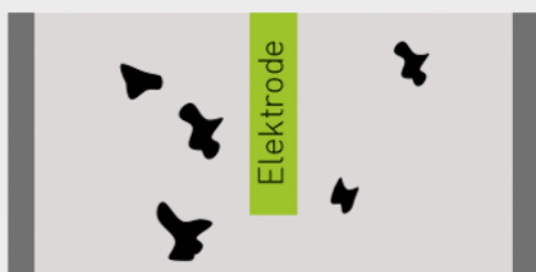
01 Jemné čiastočky prachu prúdia so spalinami cez výmenník tepla a potom do trubic integrovaného E-filtra
