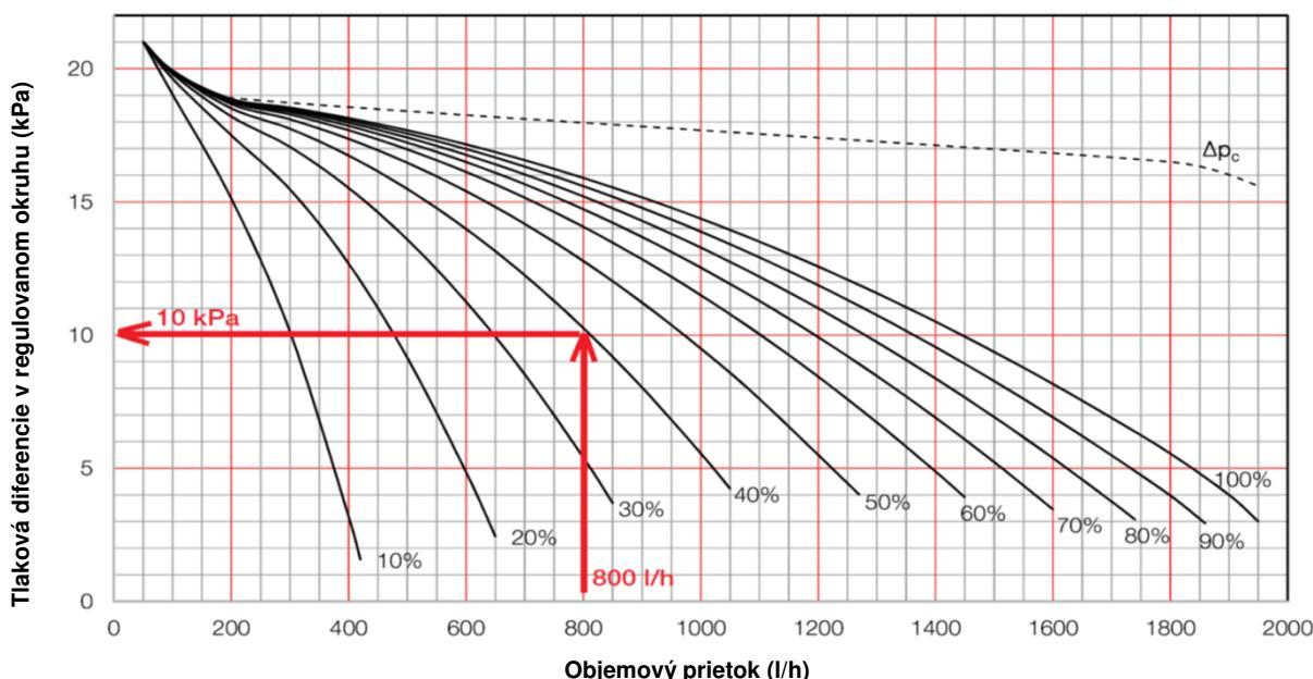
Pri zvolenom nastavení 40 % na ventile DN 20 LP 4012 je v okruhu k dispozícii diferenčný tlak 10 kPa. Pri tomto diferenčnom tlaku (po odpočítaní tlakových strát v potrubíach a armatúrach) môžu byť termostatické ventily na radiátoroch navrhnuté tak, aby pri tomto tlakovom spade vytvárali požadovaný priestok. To znamená, že na ventiloch musí byť nastavená zodpovedajúca hodnota kv.
