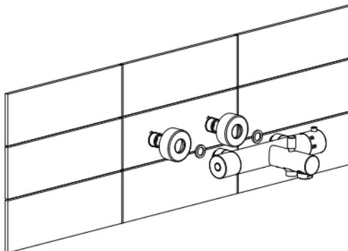
Ekscentre zidnih armatura uvrnuti u dovodne cevi pod pravim uglom sa viljuškastim ključem. Navrnite ukrasne rozetne na ekscentre.
