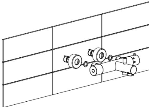
Helyezze be a tömítéseket az anyákba, majd szerelje vissza a csaptelepet egy 30-as villáskulccsal. Ellenőrizze a csatlakozások tömítettségét.
