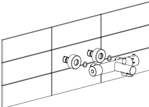
Do matice vložíme tesnenie a armatúru priskrutkujeme vidlicovým kľúčom 30.
