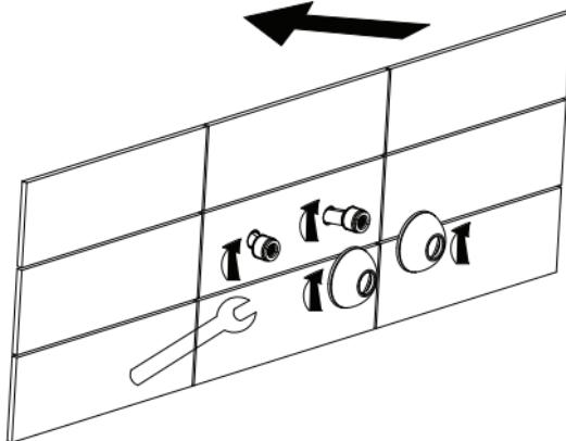
S- prípojky priskrutkujeme na prívodné rúry v pravom uhle na stenu vidlicovým kľúčom. Na S- prípojky priskrutkujeme ozdobné rozety.
