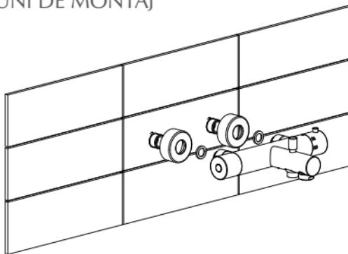
Introduceți garniturile în piulițe și fixați bateria cu ajutorul unei chei fixe de 30 mm. Verificați etanșeitatea garniturilor.
