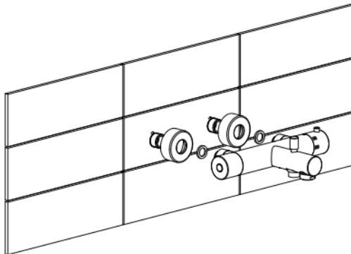
Die Dichtungen in die Muttern einsetzen und die Armatur mit einem Gabelschlüssel SW 30 einschrauben. Die Abdichtungen der Anschlüsse überprüfen.
