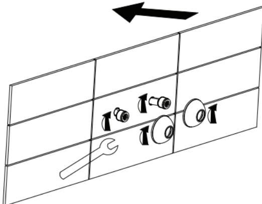
Međuosno rastojanje podesiti prema međuosnom rastojanju armature i namesrite ih na istu visinu.
