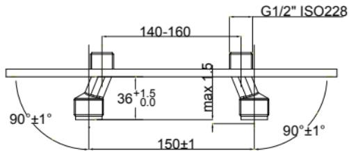
Osovú vzdialenosť prispôsobíme osovej vzdialenosťi armatúry a nastavíme ich v rovnakej výške.
