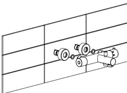
S-přípojky přešroubujeme na přívodní potrubí na stěnu pod pravým úhlem vidlicovým klíčem. Na S-přípojky našroubujeme ozdobné rozety.
