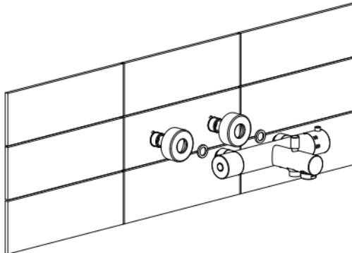
переходы эксцентр следует с помощью гаечного ключа ввинтить в трубы входа перпендикулярно стене. На переходы эксцентр навинтите декоративные розетки.
