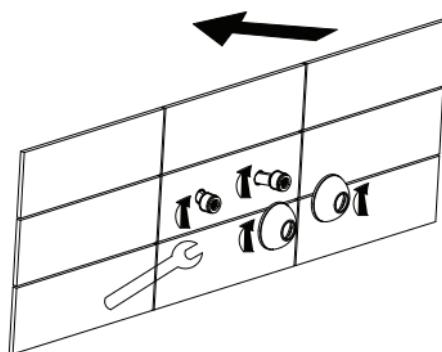
Do matice vložíme těsnění a armaturu přešroubujeme vidlicovým klíčem 30.
