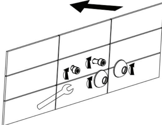
вставьте уплотнения в гайку и смеситель затяните с помощью гаечного ключа 30, проверьте герметичность соединений.
