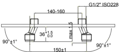
Adaptați distanța interaxială cu cea a bateriei și reglați-le la aceeași înălțime.
