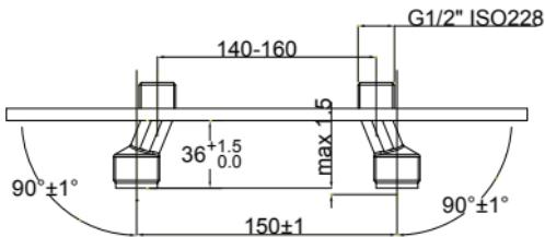
отрегулируйте колесную базу согласно колесной базе смесителя и установите их на том же уровне.
