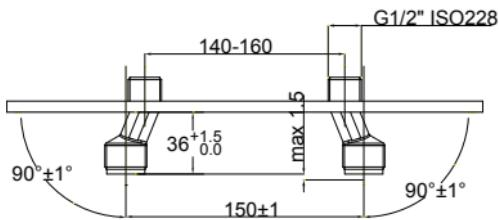
Osovou vzdálenost přizpůsobíme osově vzdálenosti armatury a nastavíme je do stejné výšky.
