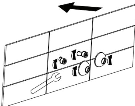
Sie S-Anschlüsse müssen mittels Gabelschlüssel in die Zuflussrohre eingeschraubt werden.
