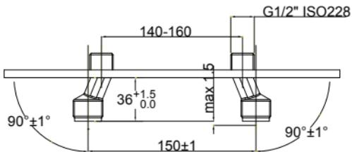
Postavite zaptivače u navrtke i armaturu montirajte sa viljuškastim ključem 30, proverite zaptivanje.
