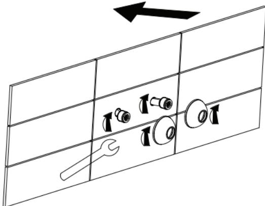
Racordurile în formă de S vor fi montate pe conductele de intrare, perpendicular pe perete, cu ajutorul unei chei fixe. Înșurubați rozetele decorative pe racordurile în formă de S.
